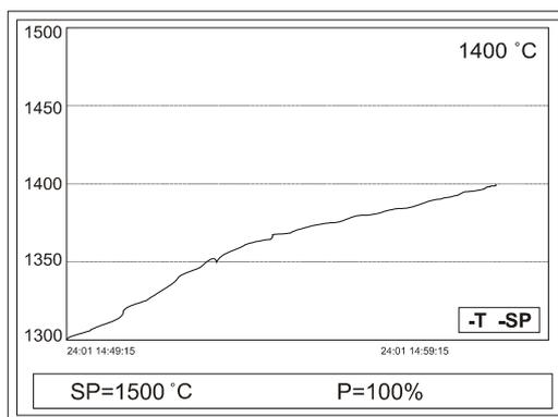
Третий режим – режим вывода на экран подробной информации. В этом режиме выводится информация о состоянии процесса, его график и текущее время, а также закон регулирования и уставка.
