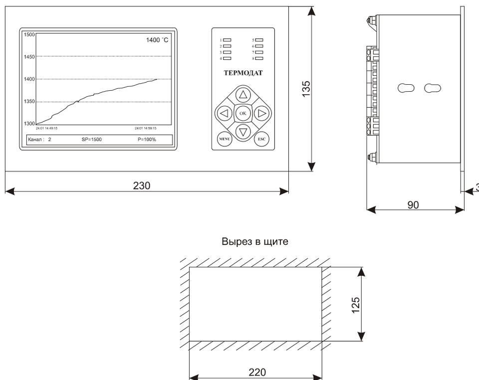
Следует обратить внимание на рабочую температуру в шкафу, она не должна превышать 45°C. Если температура выше, следует принять меры по охлаждению приборного отсека. В большинстве случаев в умеренной климатической зоне достаточно обеспечить свободную конвекцию, сделав вентиляционные вырезы в шкафу (внизу и вверху), но может потребоваться и установка вентилятора.
